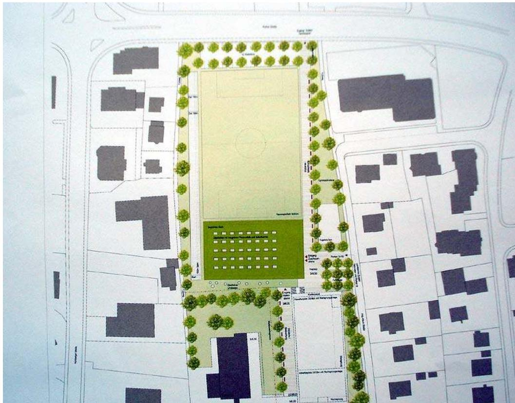
Die halbeingegrabene Sporthalle liegt im Zentrum des Grundstücks und ermöglicht eine optimale Anbindung an die Schule auf der unteren Ebene. Der Zugang für Vereinssport und Zuschauer auf der oberen Ebene über einen gut bemessenen Vorplatz im Osten ist gut gelöst. Die Stellplätze sind direkt an der Fürther Straße angeordnet und über einen ansprechenden Zugang an Vorplatz und Sporthalle angebunden.
