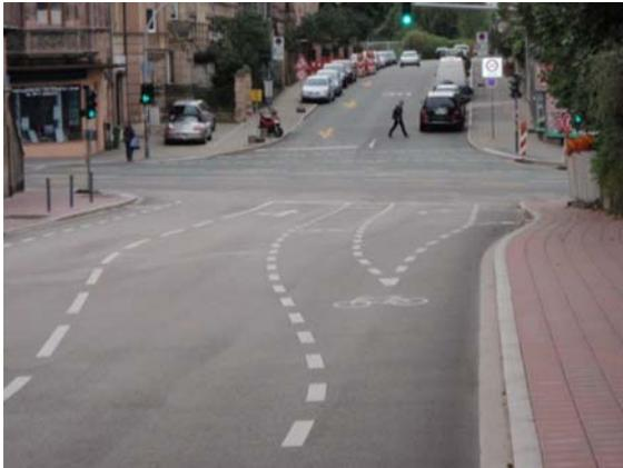
Markierung von Radschutzstreifen auf Abbiegespuren (Fürth)
