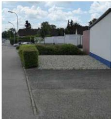
Die Ableitung von Regenwasser von Garagendächern erfolgt manchmal unkontrolliert im Kiesbett. Eine Nutzung von Regenwasser bzw. eine sinnvolle Regenwasserableitung ist insgesamt zu prüfen. Gleichzeitig sollte eine Erfassung von Schmutz- und Regenwasser mit dem Ziel eine Trennkanalisation zu errichten, geprüft werden. (Photo Nr 20)
