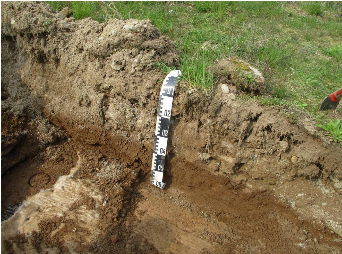
Die Reku-Schicht ist ca. 60 cm stark. Weder in der Dränmatte noch in der mineralischen Dichtung konnten Wurzeln festgestellt werden.
