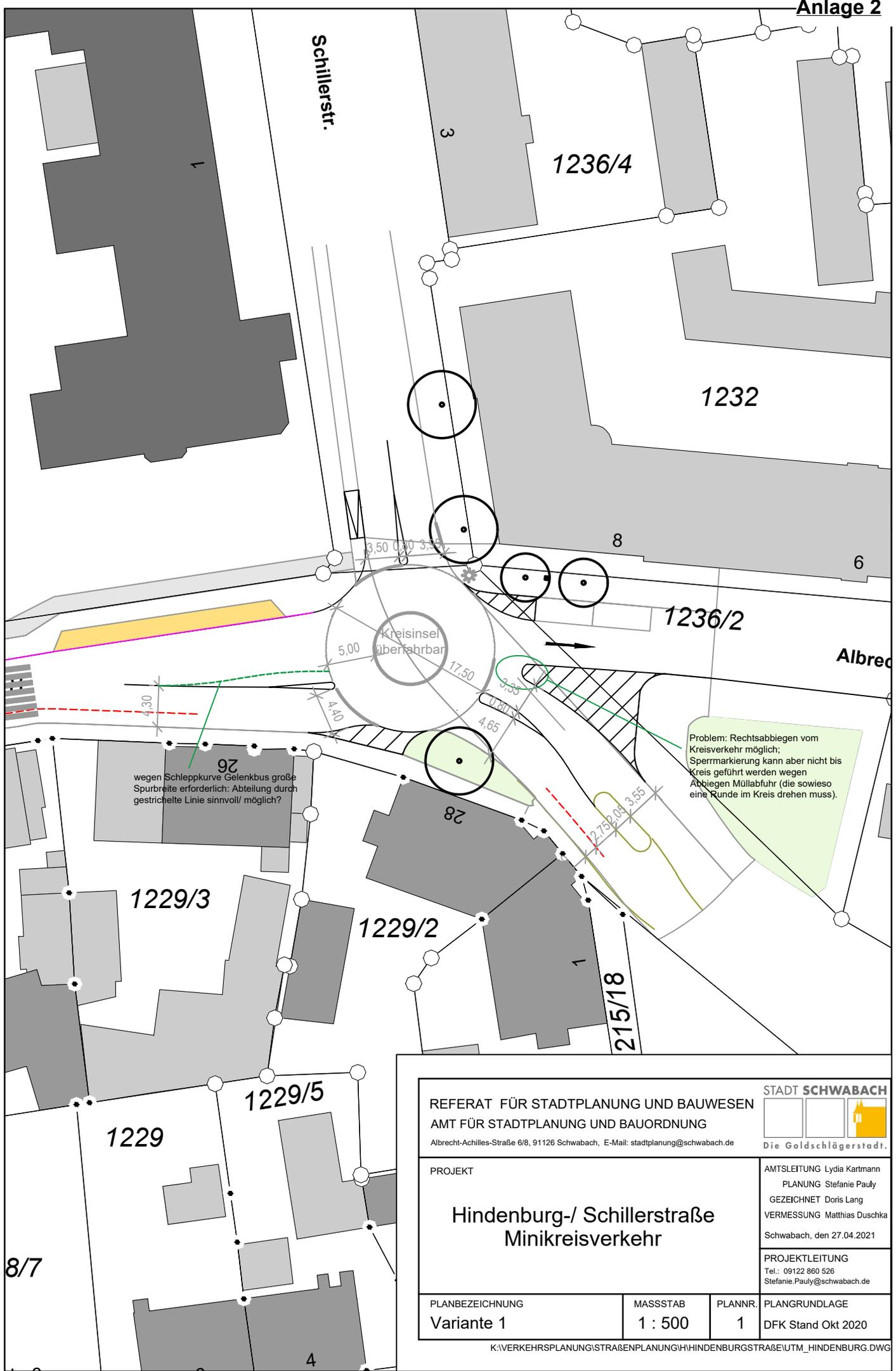
wegen Schleppkurve Gelenkbus große Spurbreite erforderlich: Abteilung durch gestrichelte Linie sinnvoll/ möglich?
