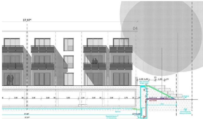
Abb.: Schnitt Tiefgarage mit unterliegenden Rigolenbox
