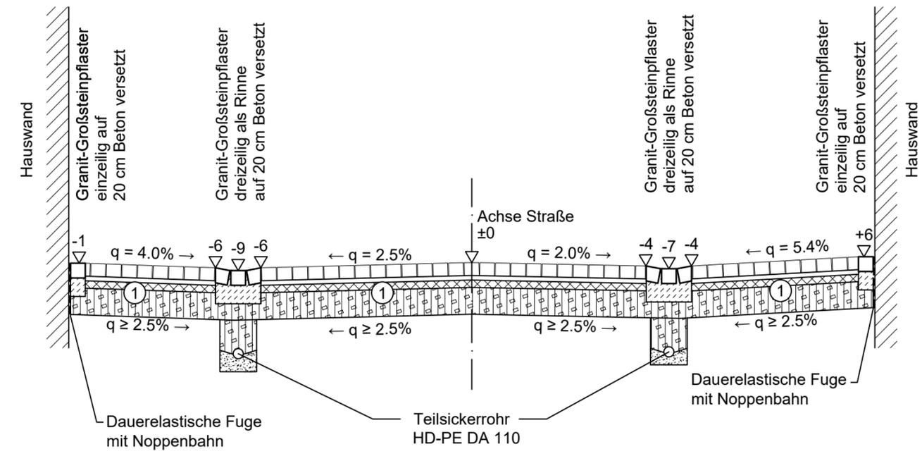
① Regelaufbau Pflaster Fahrbahn (versickerungsfähig):
